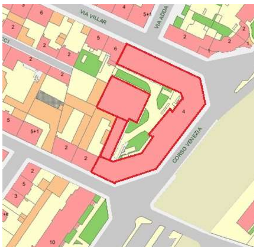
Figura 4.5. Planimetria con indicazione del numero di piani degli edifici adiacenti al complesso scolastico (elaborazione da Geoportale Comune di Torino)
