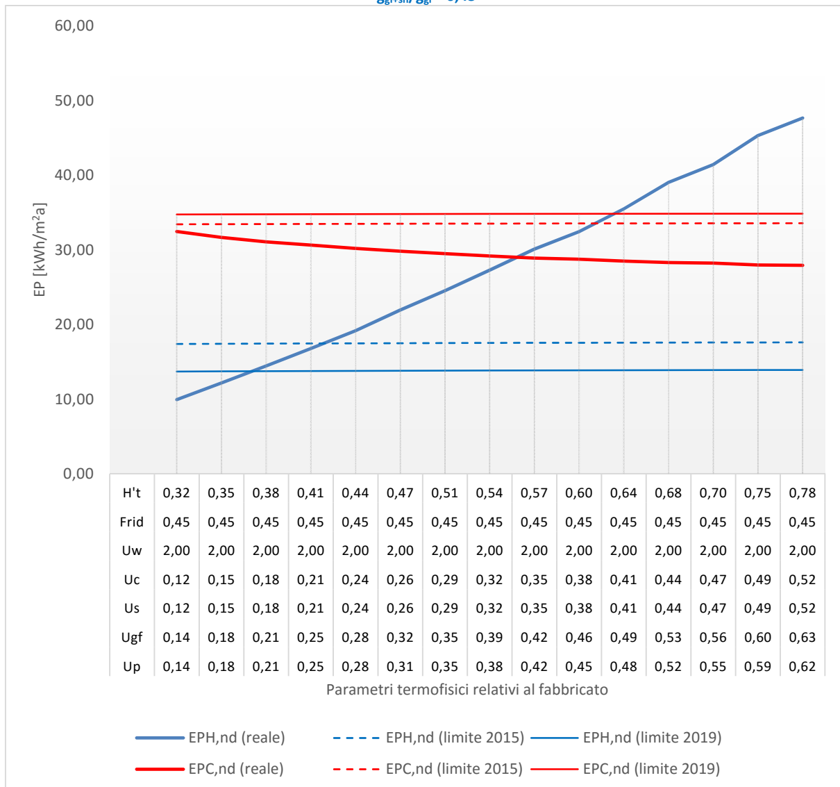
Figura 39 – Villa monofamiliare - Località Roma (Zona climatica D). Variazione di tutti i parametri relativi al fabbricato ad eccezione della trasmittanza termica delle chiusure tecniche trasparenti U_w=2,00 \text{ W/m}^2\text{K} e del fattore di riduzione g_{gl+sh}/g_{gl} = 0,45
