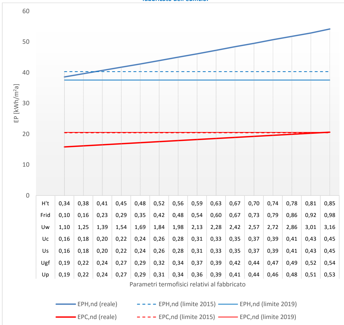
Figura 78 – Edificio ad uso scolastico – Località Roma (Zona climatica D). Variazione di tutti i parametri relativi al fabbricato dell'edificio.
