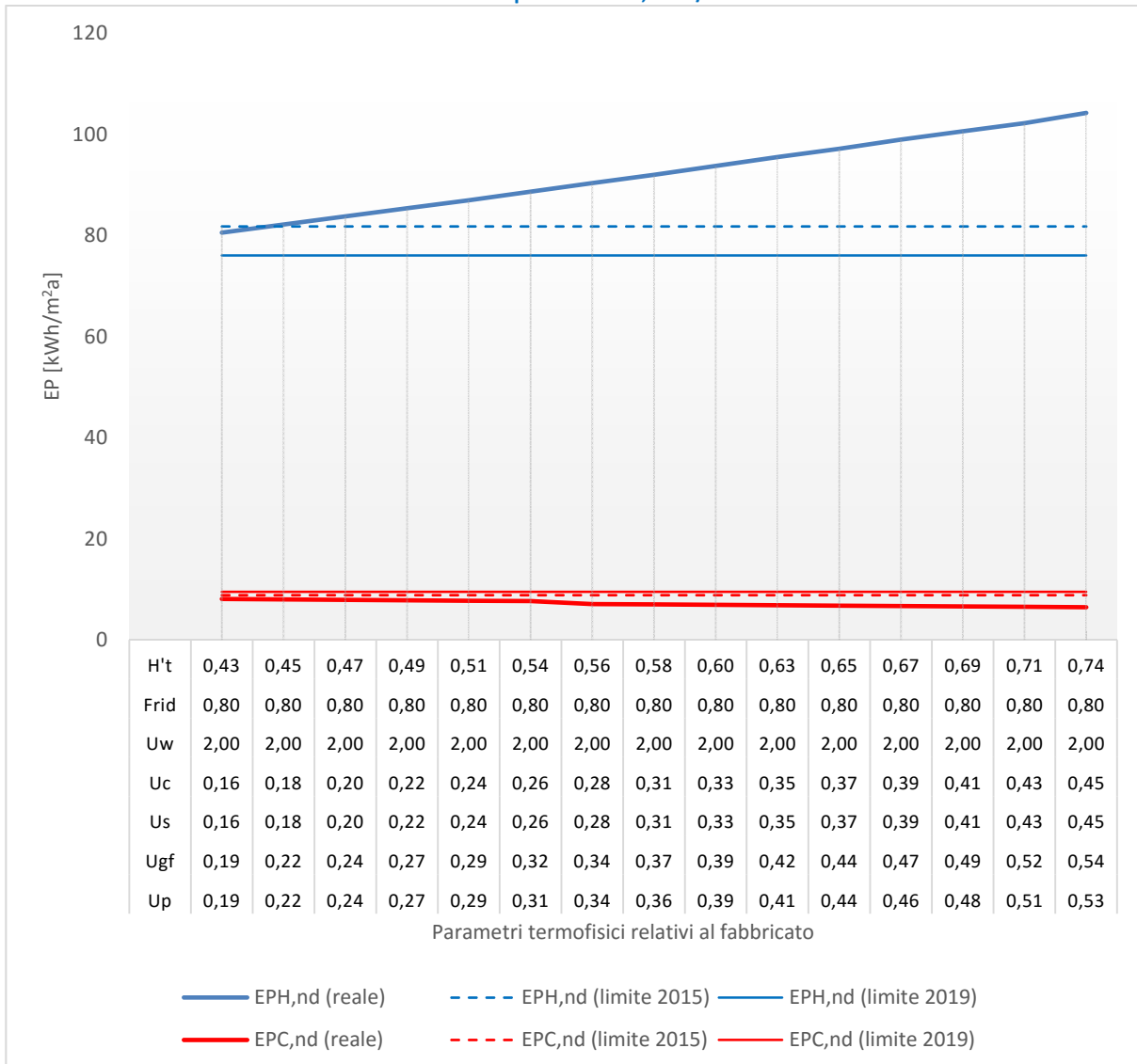
Figura 95 – Edificio ad uso scolastico - Località Torino (Zona climatica E). Variazione di tutti i parametri relativi al fabbricato ad eccezione del fattore di riduzione g_{gl+sh}/g_{gl} = 0,80 e della trasmittanza termica delle chiusure tecniche trasparenti U_w=2,00 \text{ W/m}^2\text{K}
