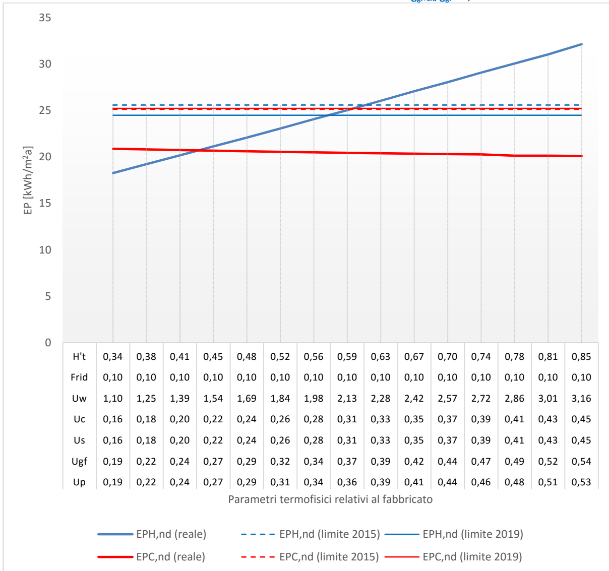
Figura 61 – Edificio ad uso scolastico - Località Palermo (Zona climatica B). Variazione di tutti i parametri relativi al fabbricato ad eccezione del fattore di riduzione g_{gl+sh}/g_{gl} = 0,10
