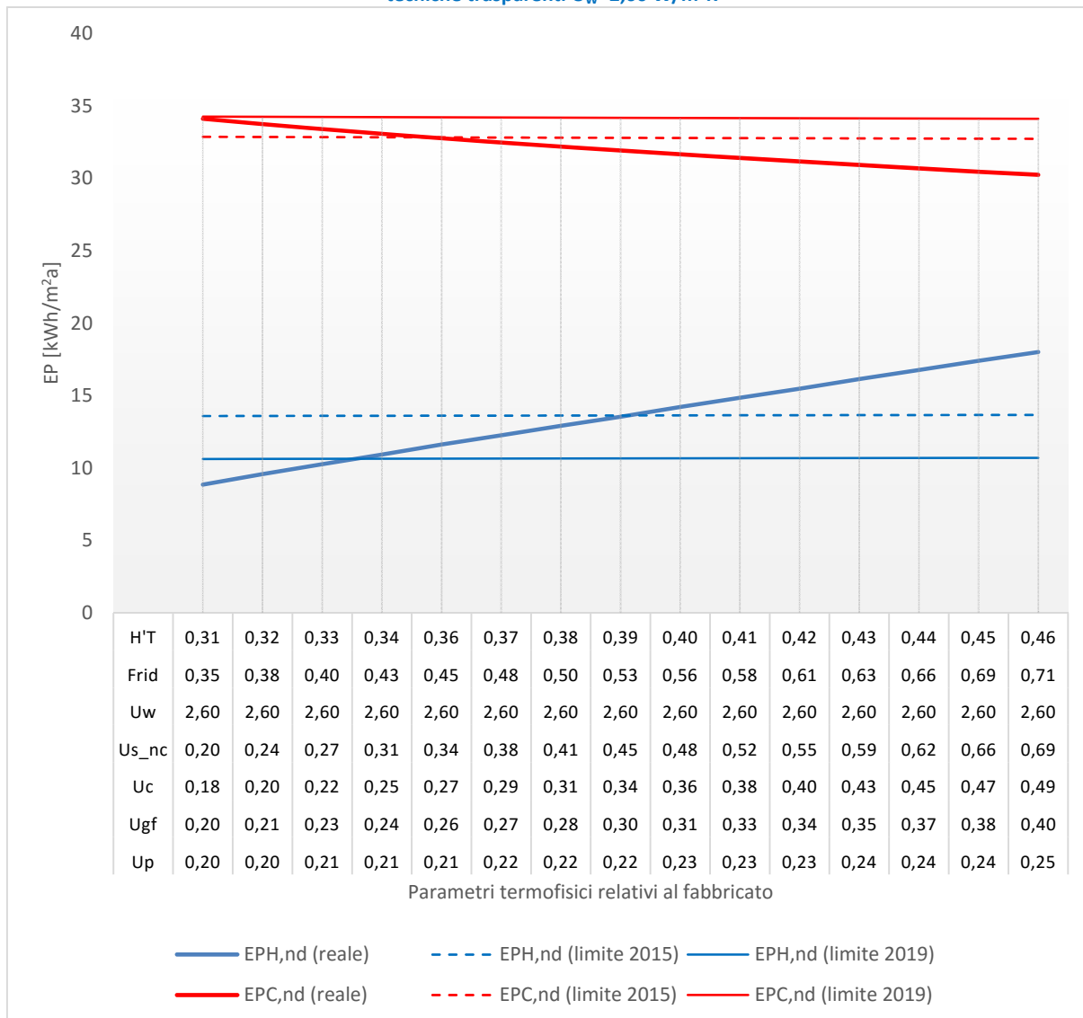
Figura 178 – Palazzina con destinazione d’uso residenziale - Località Roma (Zona climatica D). Unità Immobiliare U.I8. Variazione di tutti i parametri relativi al fabbricato dell’edificio ad eccezione della trasmittanza termica delle chiusure tecniche trasparenti U_w=2,60 \text{ W/m}^2\text{K}
