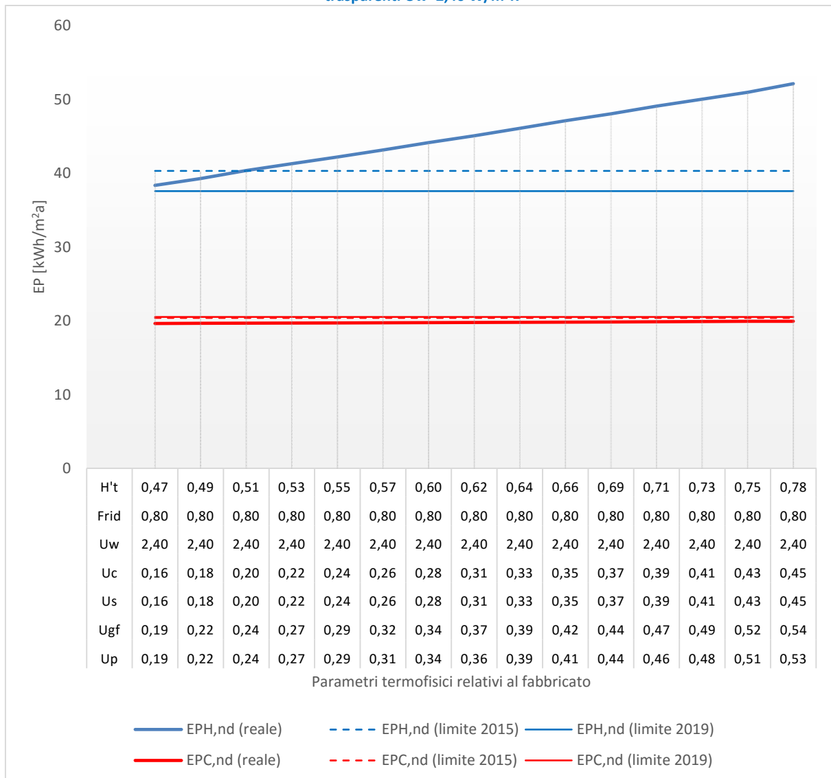
Figura 85 – Edificio ad uso scolastico - Località Roma (Zona climatica D). Variazione di tutti i parametri relativi al fabbricato ad eccezione del fattore di riduzione g_{gl+sh}/g_{gl} = 0,80 e della trasmittanza termica delle chiusure tecniche trasparenti U_w=2,40 \text{ W/m}^2\text{K}
