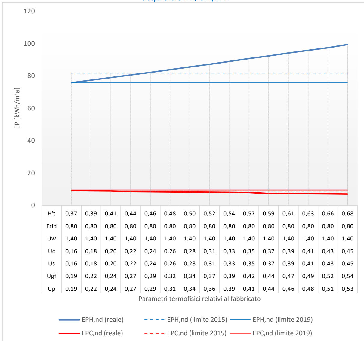
Figura 93 – Edificio ad uso scolastico - Località Torino (Zona climatica E). Variazione di tutti i parametri relativi al fabbricato ad eccezione del fattore di riduzione g_{gl+sh}/g_{gl} = 0,80 e della trasmittanza termica delle chiusure tecniche trasparenti U_w=1,40 \text{ W/m}^2\text{K}
