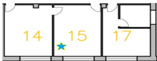
Figura 6.31. Pianta ufficio 15 – Piano terra. Il posizionamento dei Tinytag è indicato dalla stellina celeste.
