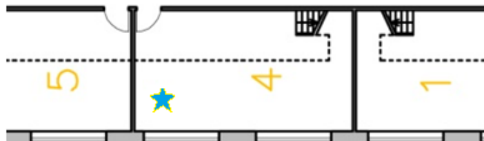
Figura 6.39. Pianta ufficio 4– Piano terra. Il posizionamento dei Tinytag è indicato dalla stellina celeste.
