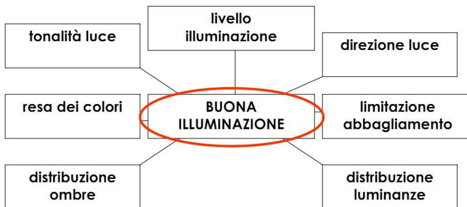
Figura 2.6. Parametri coinvolti nella progettazione illuminotecnica [12]
