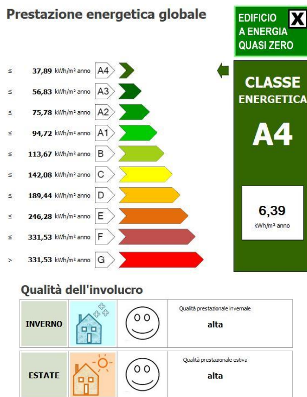
Figura 93. Classificazione energetica dell'edificio ristrutturato
