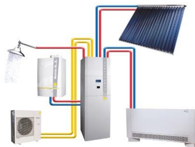
Fig. 21 – sistema integrato di climatizzazione ed ACS a pompa di calore
