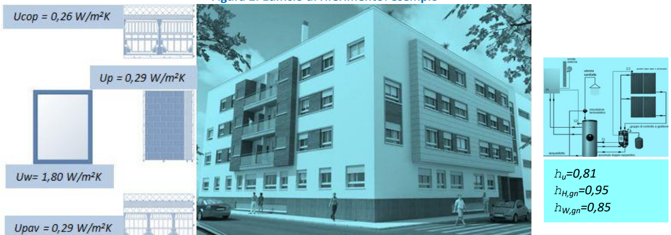
Figura 2: Edificio di riferimento: esempio
