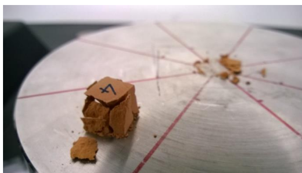
Figura 1. Rottura di un provino a fine test.
