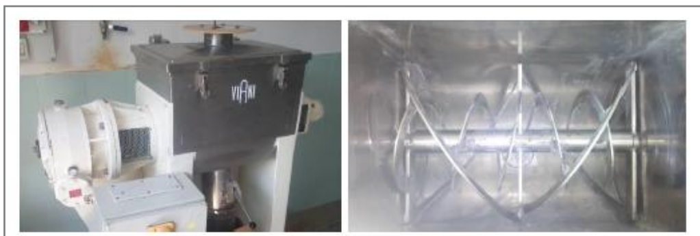
Figura 13. Miscelatore a 4 vie (sinistra) e particolare dell'elica di miscelazione (destra).
