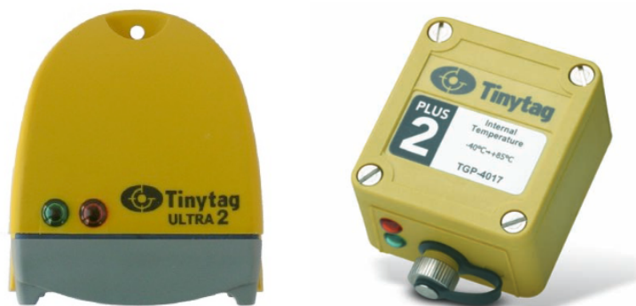
Figura 2.6. Sensori utilizzati per misure di temperatura e umidità all'interno ed all'esterno.
