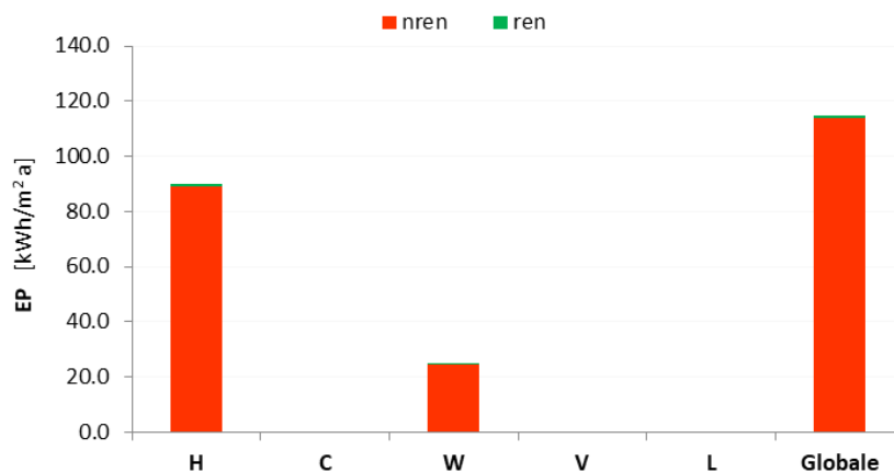
Figura 4.27. Prestazione energetica dell'appartamento-tipo (valutazione adattata all'utenza calibrata).
