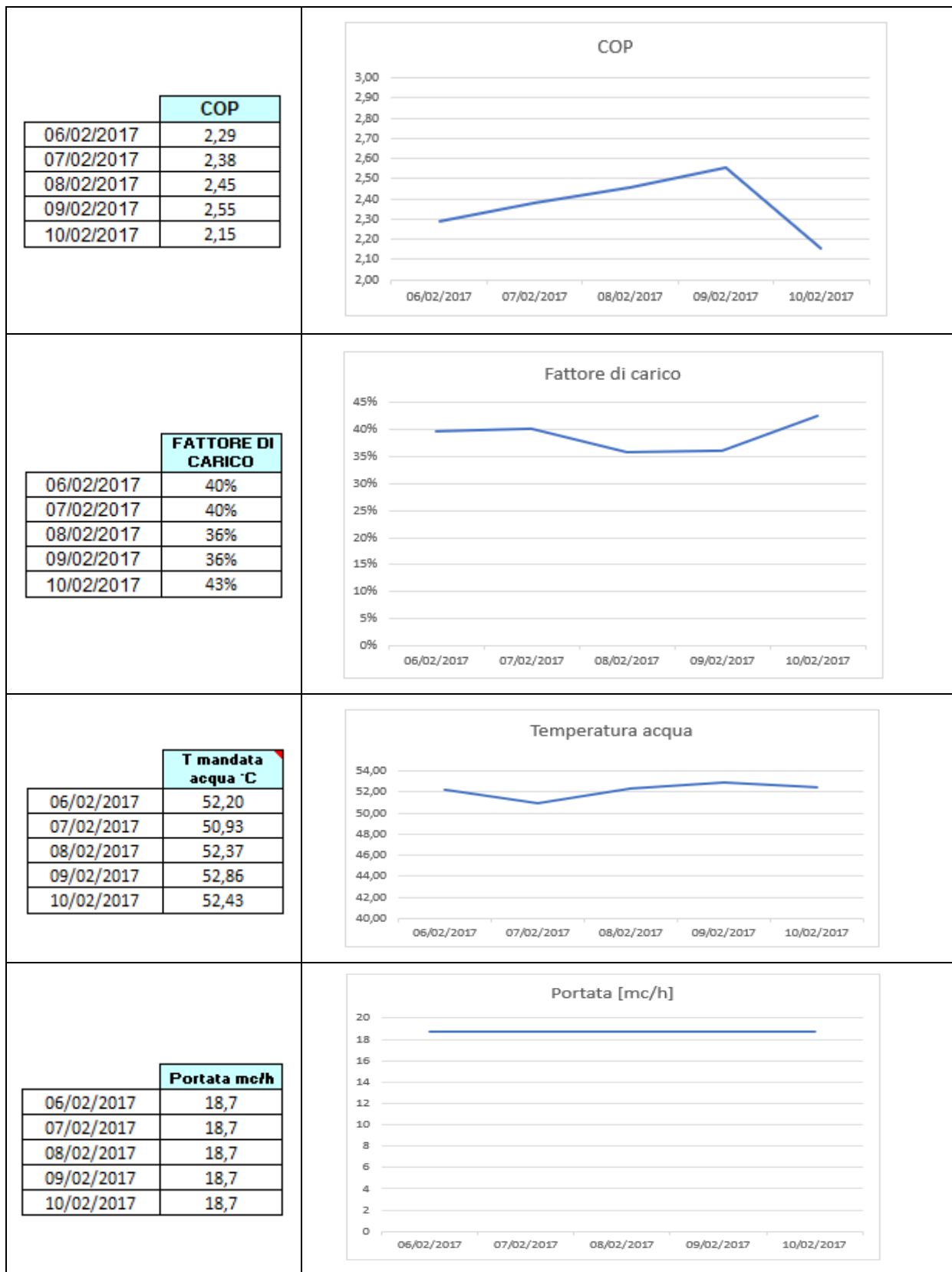
Fig. 15 COP, Fattore di carico, Temperatura acqua e portata 6-10 Febbraio 2017 Direzione di Nizza Monferrato
