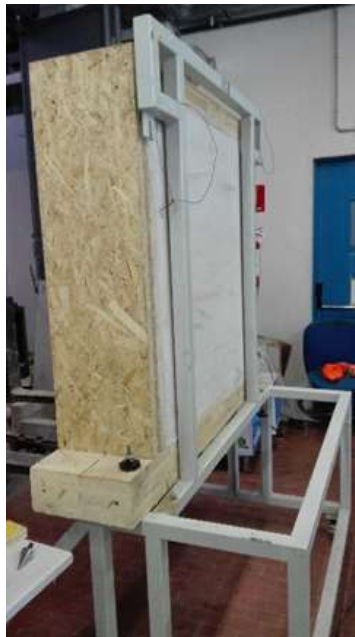
Figura 4: Fasi di posa della parete sul carrello metallico
