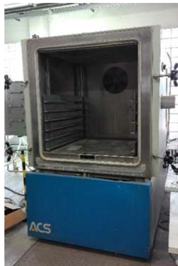
Figura 2: Camera climatica utilizzata (Angelantoni 2100 CH)
