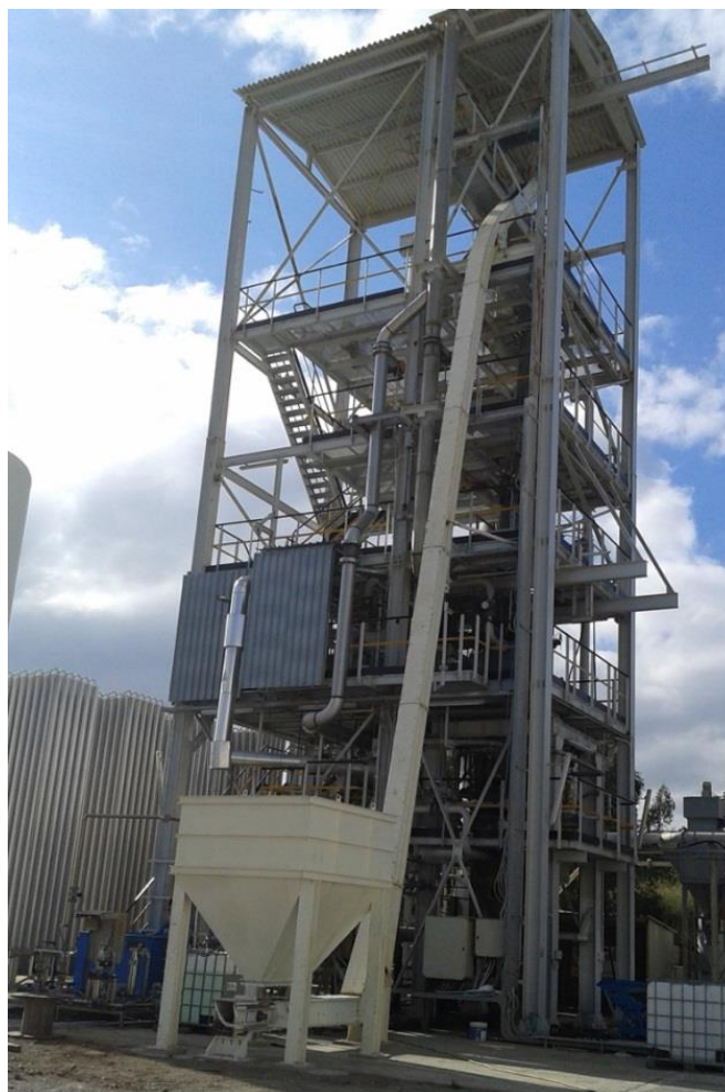
Figura 3.3.1.1. Sistema di caricamento automatico del combustibile (redler).
