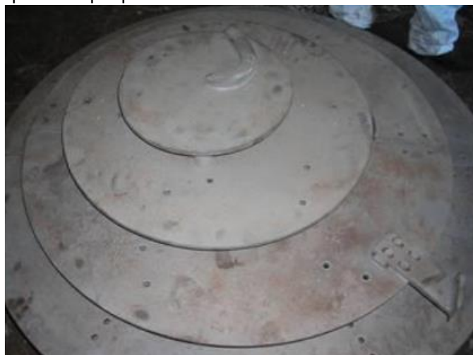
Figura 2.5. Parte esterna della griglia del gassificatore.
