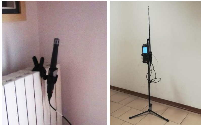
Figura 31. A sinistra: sonda per la misura della temperatura interna (punto B). A destra: centralina di acquisizione
