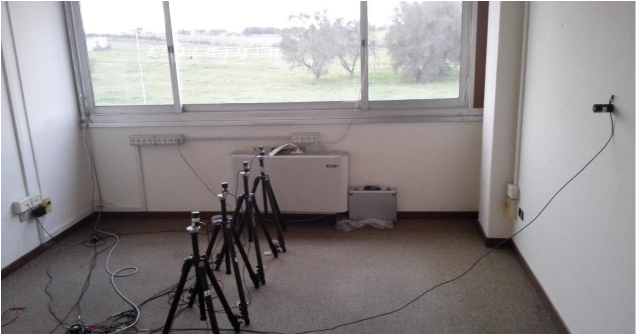
Figura 10 Ufficio del Centro Ricerche ENEA Casaccia dove è stato allestito un set di luxmetri per effettuare misurazioni sul campo.
