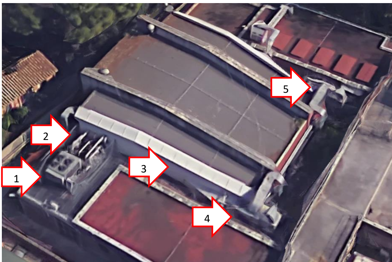
Figura 3.10 – Vista dall’alto dell’Aula Magna (Fonte Google Maps). (1) Gruppo polivalente; (2) pompe e serbatoi d’accumulo; (3) carter di protezione canalizzazioni; (4) unità di trattamento aria; (5) unità di trattamento aria
