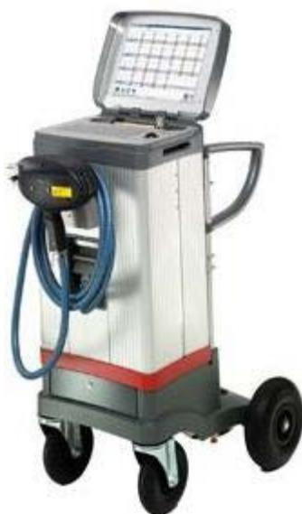
Fig. 22. Spettrometro ad emissione ottica portatile Spectrotest.
