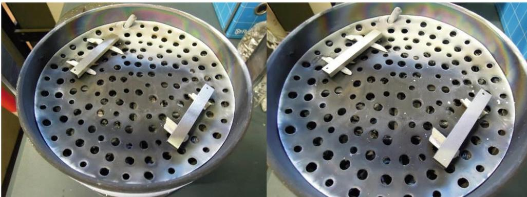
**Figura 4.6** - Aspetto dei provini prima (sinistra) e dopo (destra) il trattamento di alluminizzazione a 800 °C con stasi di 6 ore
