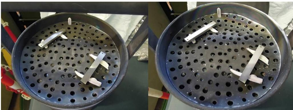
Figura 4.3 – Aspetto dei provini prima (sinistra) e dopo (destra) il trattamento di alluminizzazione a 900 °C con stasi di 2 ore
