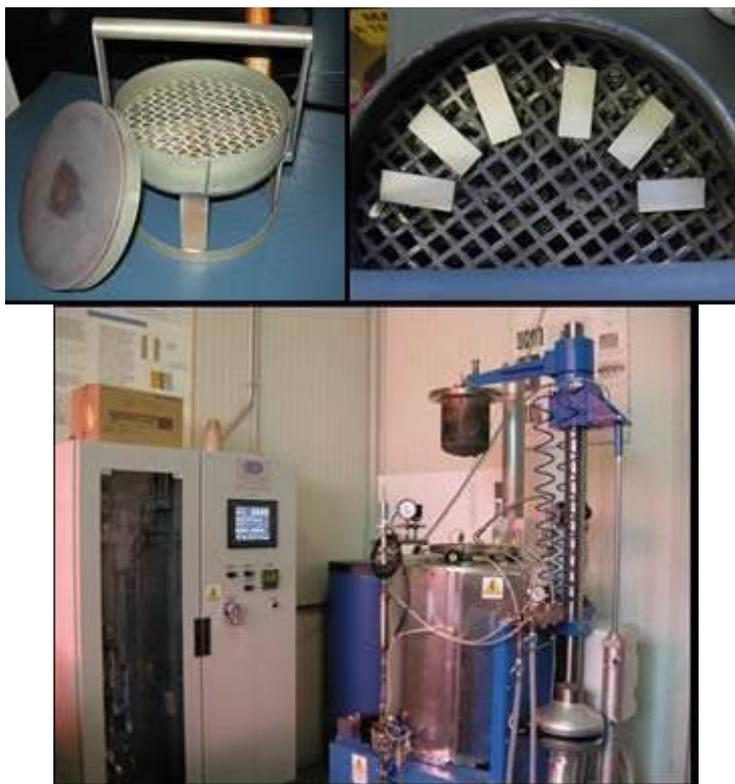
**Figura 4.1** – Impianto CSM pack cementation: (sopra) dettagli del retort e (sotto) impianto
