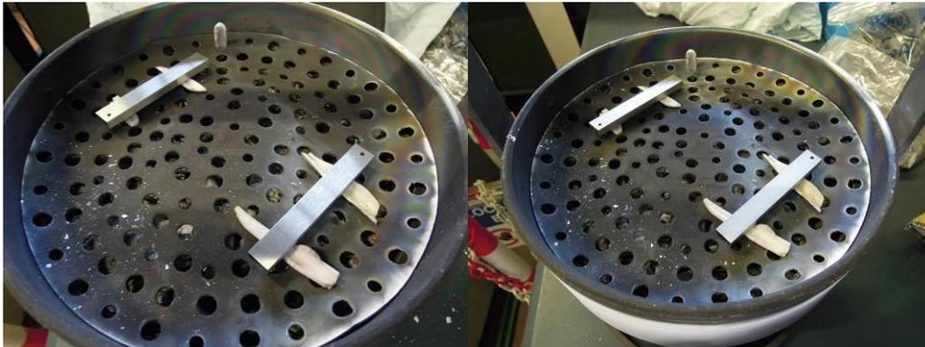
**Figura 4.4** - Aspetto dei provini prima (sinistra) e dopo (destra) il trattamento di alluminizzazione a 850 °C con stasi di 4 ore
