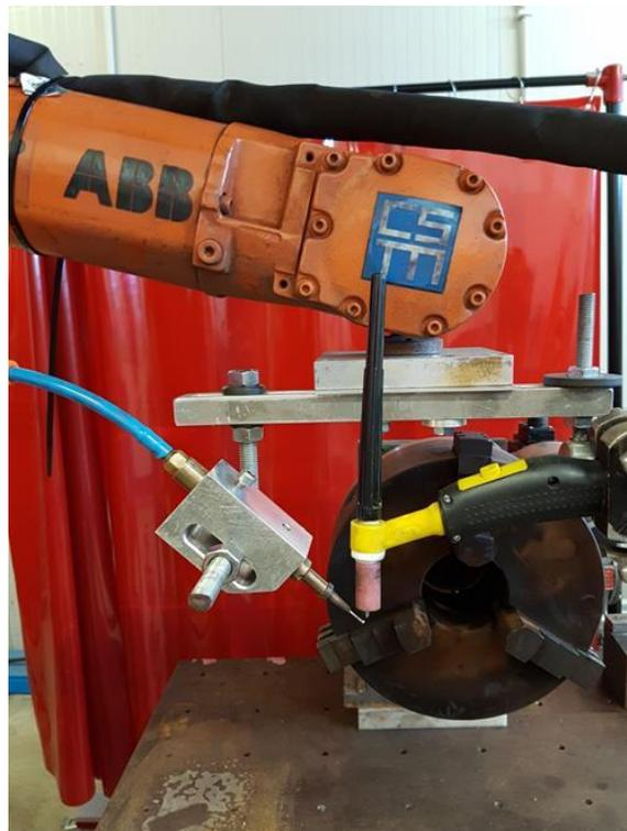
**Figura 5.2** – Sistema CSM robot per saldatura
