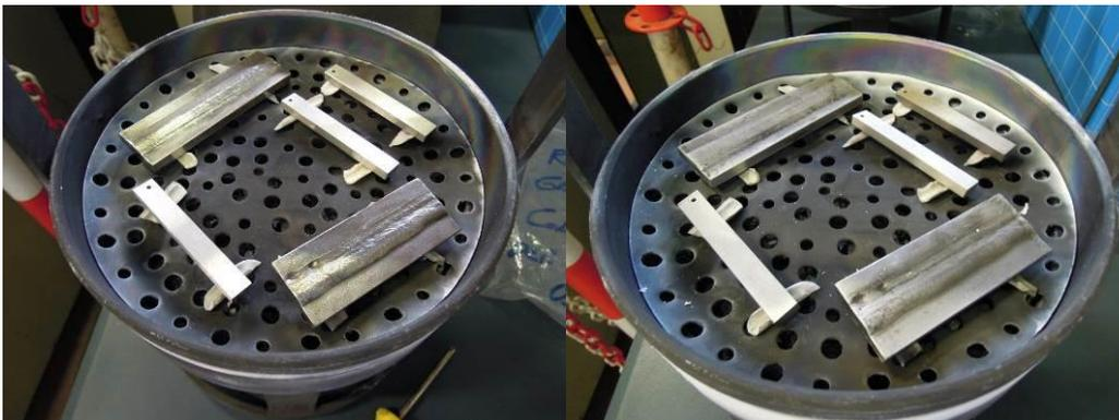
**Figura 6.1** - Aspetto dei provini prima (sinistra) e dopo (destra) il trattamento di alluminizzazione a 800 °C con stasi di 6 ore
