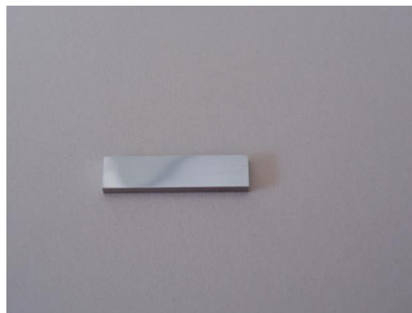
Fig. 11. Campione per Ion Irradiation 1,3x5x20 mm 3 (superficie lucidata a specchio)
