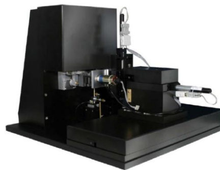
Prova di nanoindentazione UNI EN 14577/1-2
