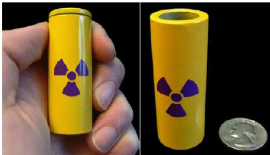
Figura 1: immagine del contenitore schermante.
