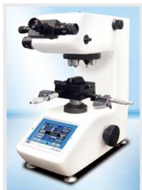
Prova di microdurezza UNI EN ISO 6507-1:2005
