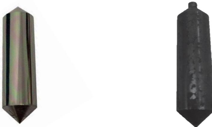
Fig. 1. Campioni sottoposti a prova di corrosione in Pb fluente, prima e dopo la prova.
