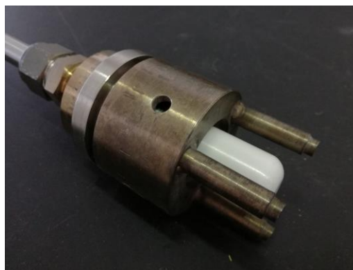
Figura 8: Sensore Pt-aria (700 mm) con elettrolita solido YPSZ.
