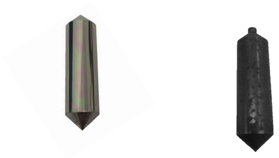
Fig. 1. Campioni sottoposti a prova di corrosione in Pb fluente, prima e dopo la prova.
