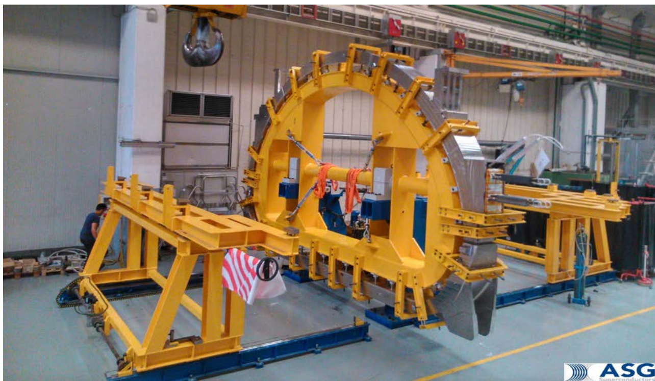
Figura 4 Modulo in posizione verticale per saldatura di giunzione delle gambe
