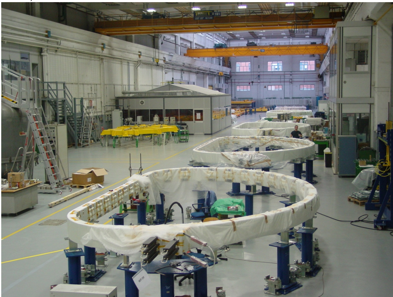
Figura 1 Vista d'insieme dell'officina ASG al termine della nastratura di embedding dei WP
