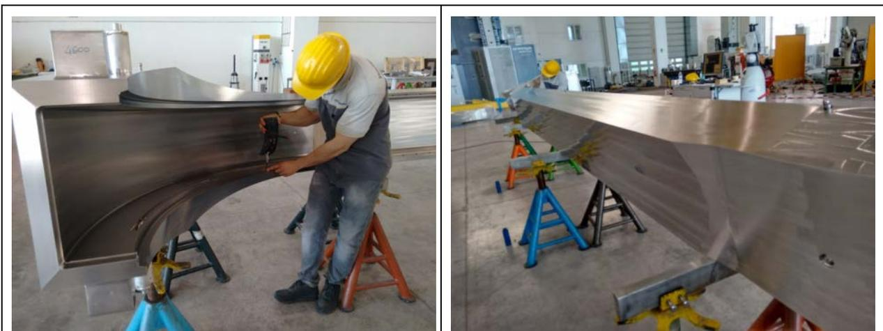
Figura 12: Controllo dimensionale della gamba dritta; particolare della misura effettuata con lo strumento T-probe.
