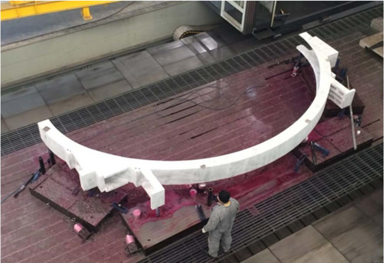
Figura 8: Controlli con liquidi penetranti sulla gamba curva al termine delle lavorazioni finali di macchina.
