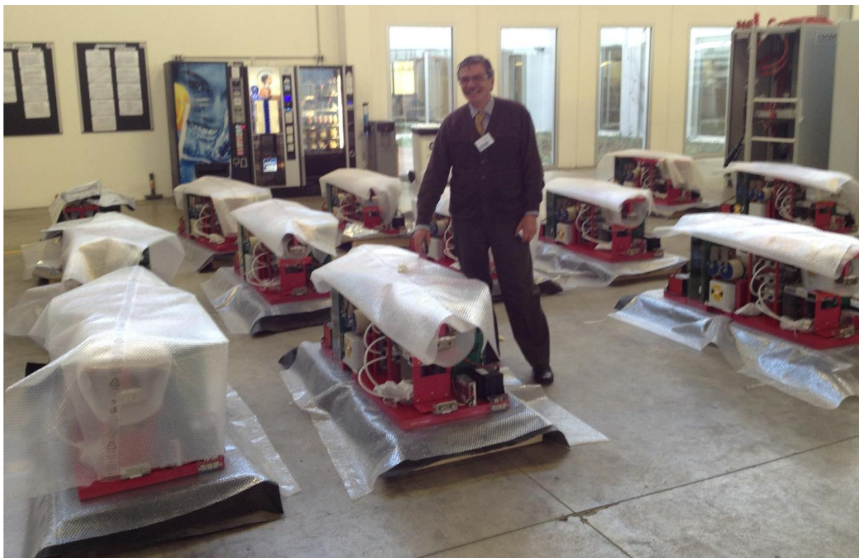
Figura 9. Stack degli SCB rimossi dai relativi cubicoli per la spedizione in casse separate. Nella foto sono visibili alcuni shock detector gialli.
