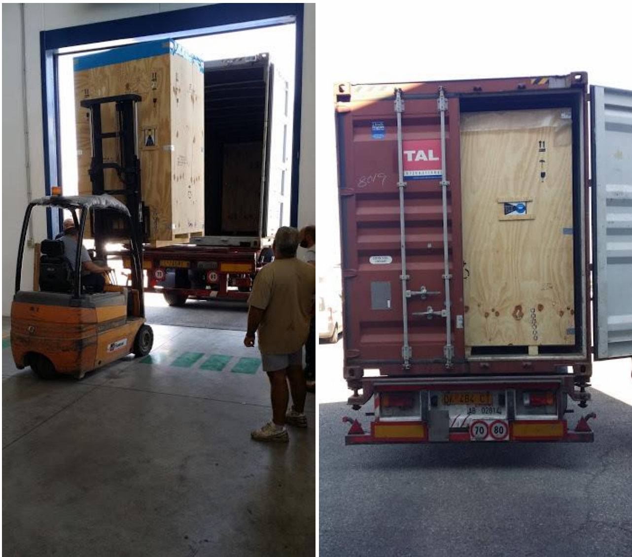
Figura 11. Carico delle casse di legno sui container per il trasporto via mare. Nelle foto sono visibili anche due shock detector (rispettivamente giallo e blu).
