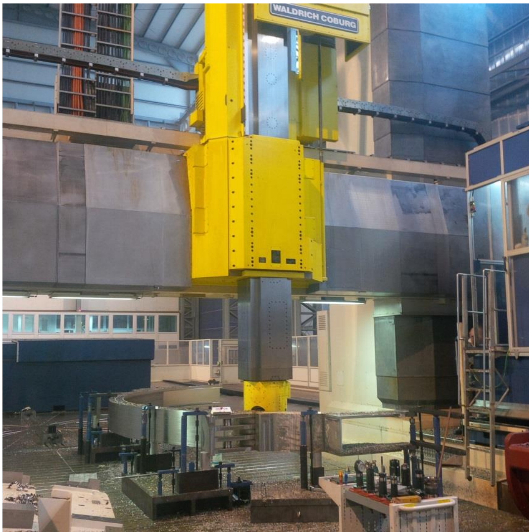
Figura 3: Lavorazioni di macchina sulla parte esterna della gamba curva nello stabilimento della ditta Walter Tosto a Ortona.
