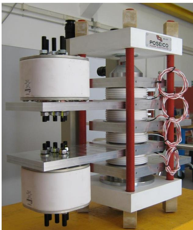
Figura 4 – Dettaglio del CS2 power assembly.
