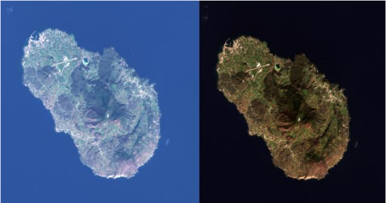
Figura 7- Immagine Sentinel 2 TOA (Top of Atmosphere) del 11-02-2016 dell'isola di Pantelleria senza alcuna correzione atmosferica (a sinistra) e dopo la rimozione della componente di scattering molecolare (Rayleigh) a destra.
