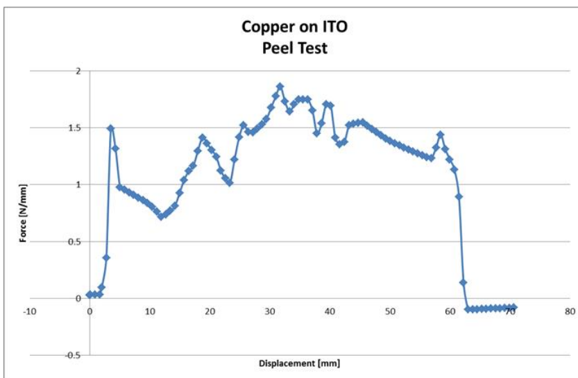
Figura 11: Peel test di campioni ITO ridotti per 4 secondi e con rame spesso 10 micron elettro-depositato
