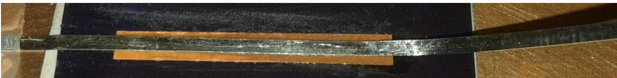
Figura 27: Campione per peel test
