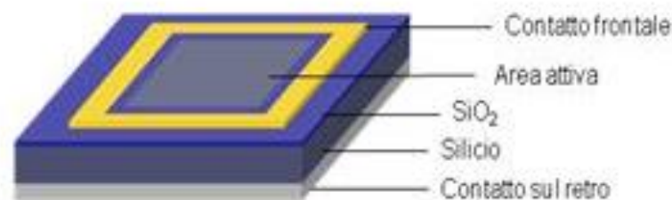
Figura 7. Schema della struttura di una cella solare Schottky basata sulla giunzione grafene/Si
