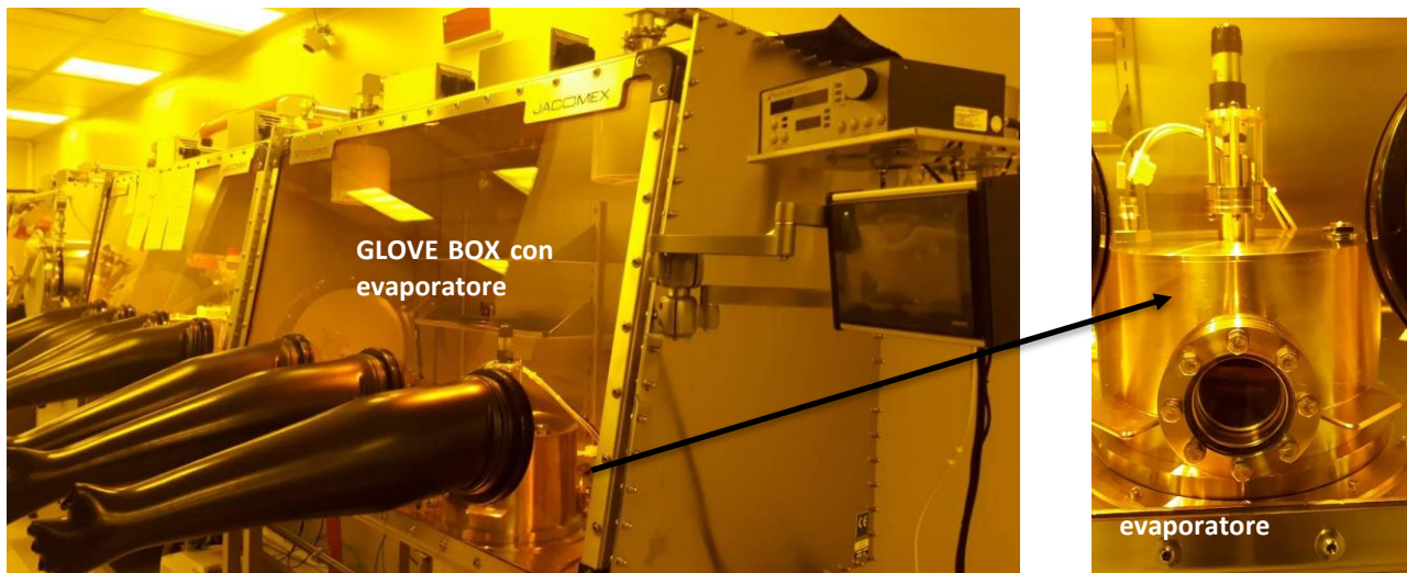
Fig. 12 (b) foto della glove box con evaporatore integrato (c) particolare dell'evaporatore termico
