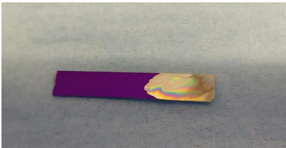
Figura 2.1.1.2: Effetto della deposizione dell'SnO 2 sull'AZO.
