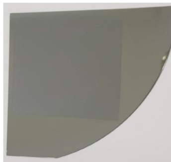
Figura 7. Foto del grafene trasferito su wafer, con area di copertura pari a 3 cm x 3 cm
