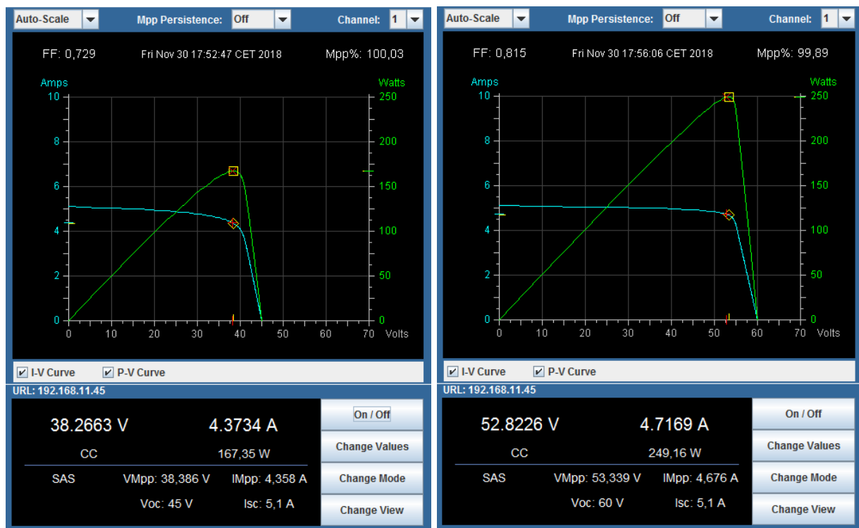
Figura 46. Misure di MPP tracking per la scheda di potenza SiC per Pin di 160 W e 250 W.
