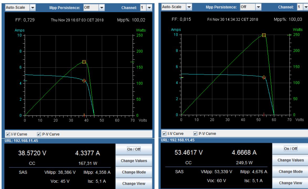
Figura 58. Misure di MPP tracking per le schede di potenza interleaved per Pin di 160.
