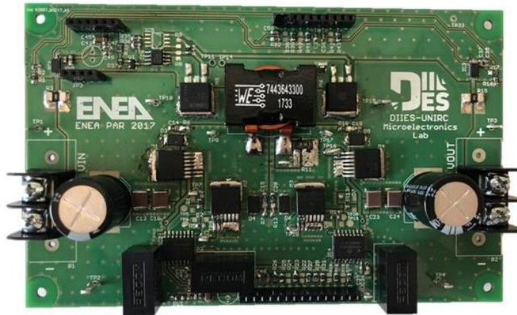
Figura 39. Top view dalla scheda di potenza in Carburo di Silicio.
