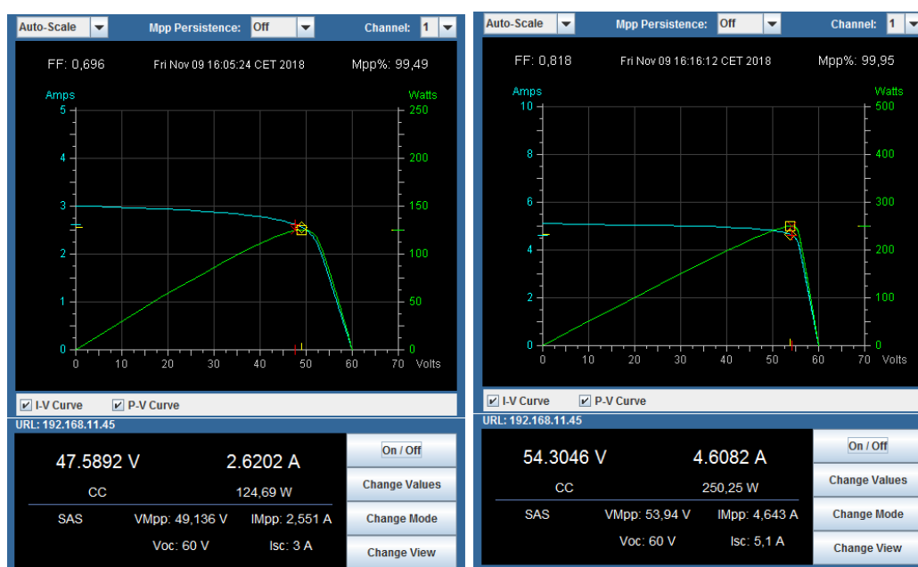
Figura 42. Misure di MPP tracking per la scheda di potenza con MOSFET in Si per Pin di 124 W e Pin di 250 W.
