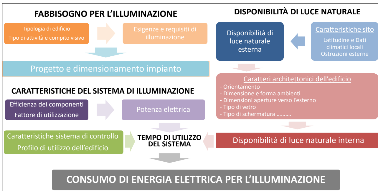
Figura 3 - Schematizzazione dei parametri che influenzano il consumo di energia elettrica per illuminazione.
