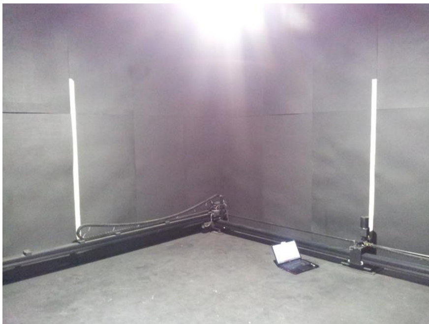
Figura 25 - L'interno della cella di prova, con il luxmetro per le misure sulla griglia orizzontale e le guide per i punti di misura su 2 pareti verticali
