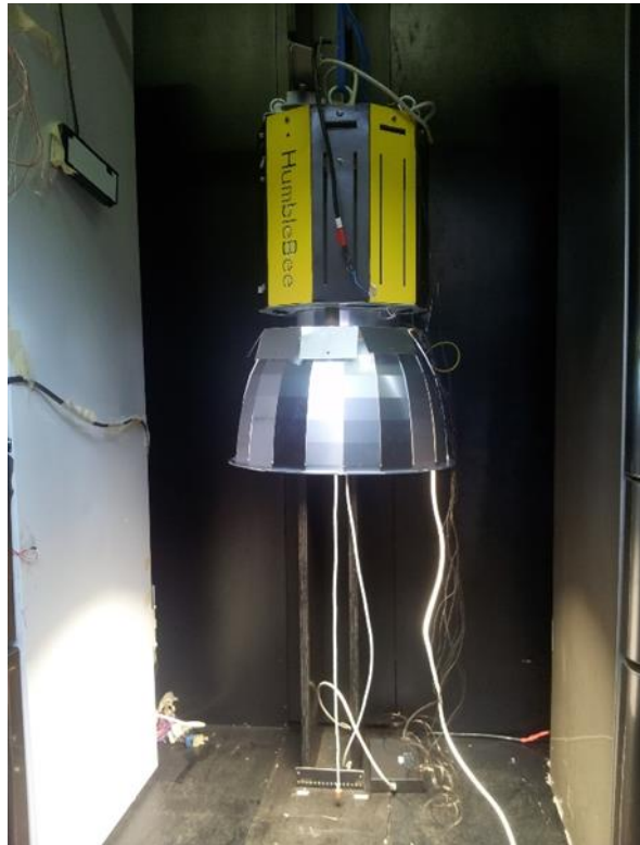
Figura 22 - L'apparecchio HumbleBee con riflettore Almecco, in prova nella camera climatica
