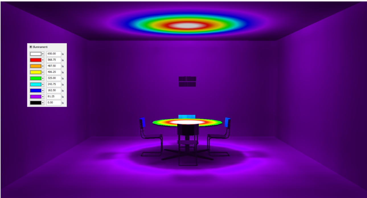
Figura 30 – Rappresentazione a falsi colori dell’illuminamento all’interno della stanza per la simulazione illuminotecnica
