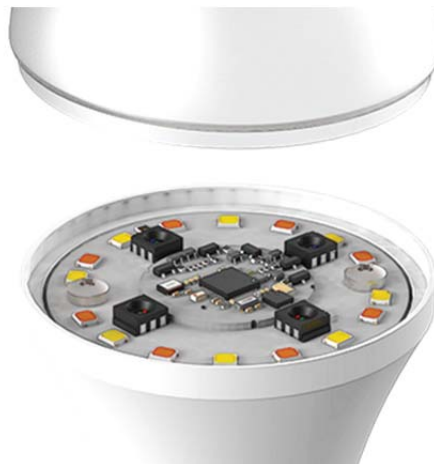
Figura 4 - LED inseriti all'interno della sorgente di illuminazione CBYGE SLEEP
