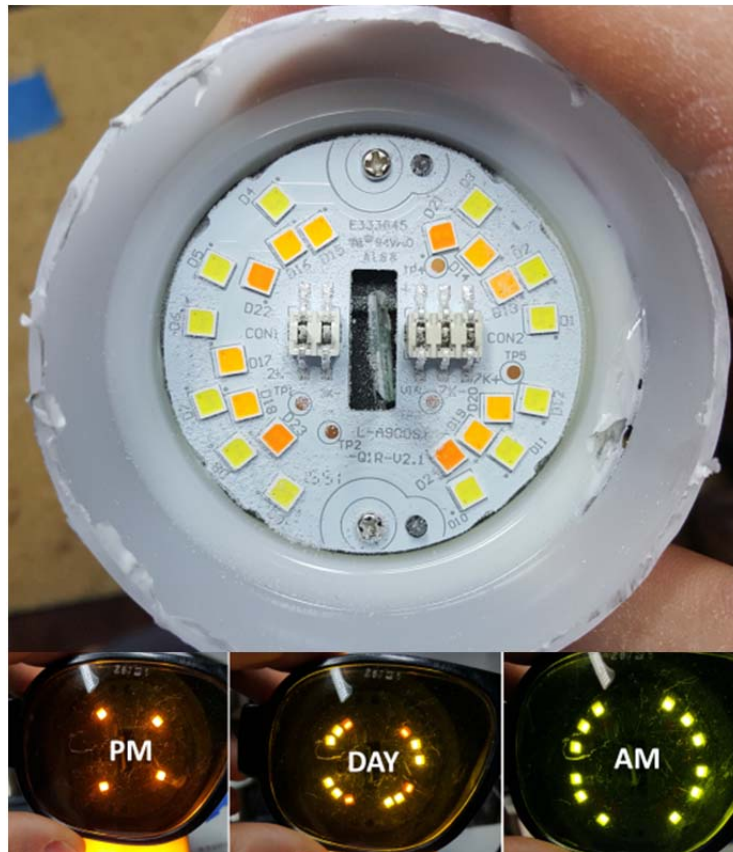
Figura 3 – LED inseriti all'interno della sorgente di illuminazione CBYGE SLEEP
