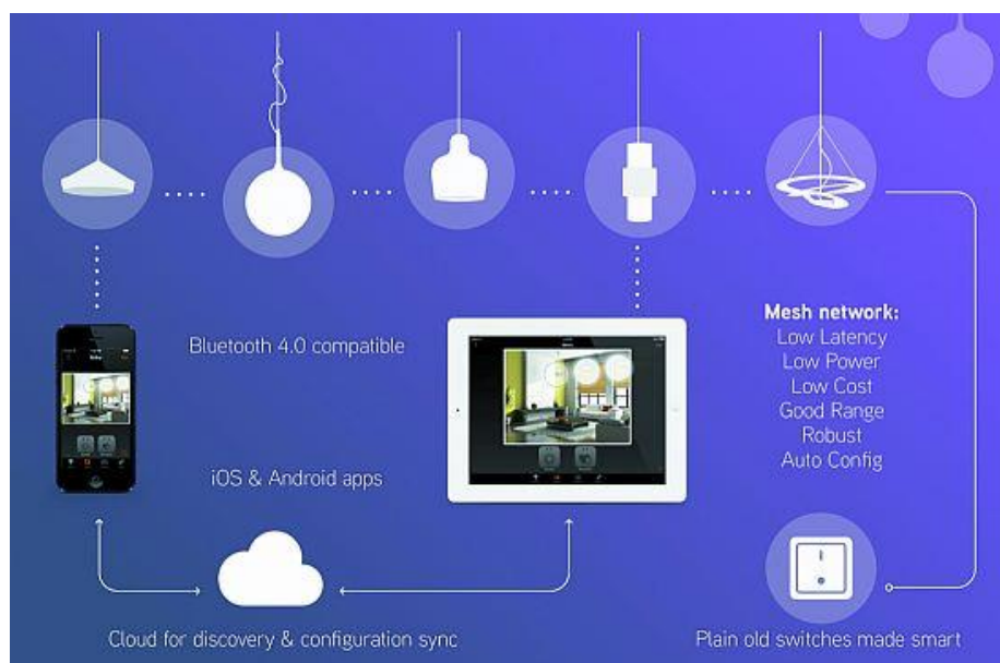
Figura 55 Doppio protocollo implementato nel sistema CASAMBI: smart blue-tooth protocol per interfacciarsi con gli smart-phone, tablet, smart-watch e un protocollo mesh proprietario per il controllo dei singoli apparecchi/sensori che costituiscono la rete
