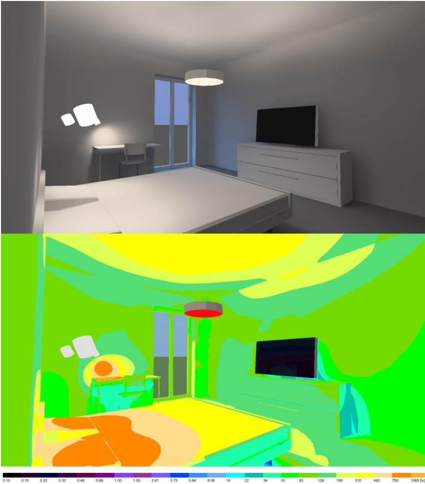
Figura 31 - Rappresentazione dello scenario di illuminazione naturale e artificiale nel locale Soggiorno. Rappresentazione dei falsi colori per i valori di illuminamento
