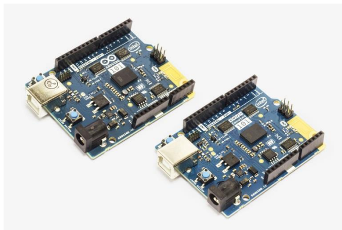
Figura 67 Sistema di prototipazione Genuino 101 basato su micro Intel Curie
