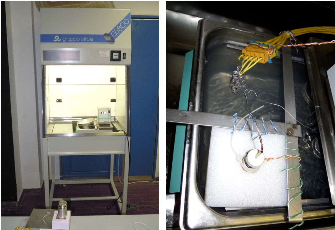
Figura 7 (a) Cappa con all'interno il bagno termostato; (b) pallone immerso nel bagno termostato.
