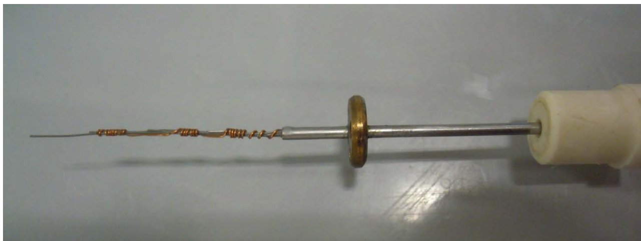
Figura 6 Termocoppie per il monitoraggio della temperature all'interno della sfera.
