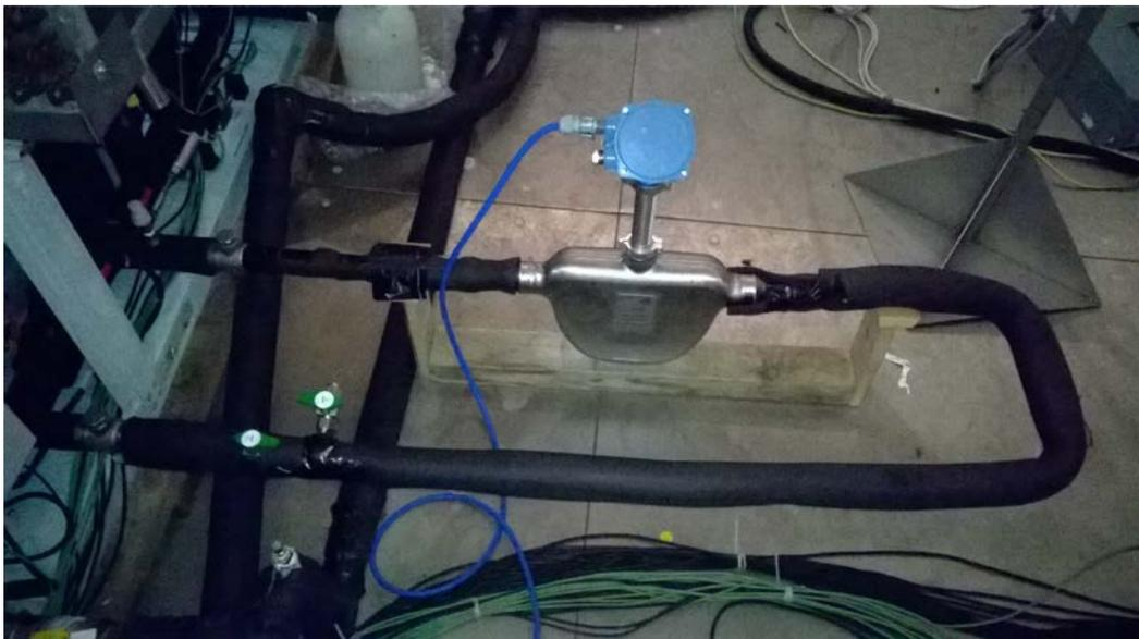
Figura 10. Misuratore di portata installato a vallo dell'IHE, lato caldo
