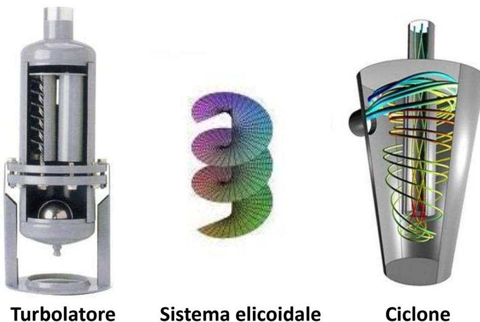
Figura 18. Componenti per separatori a centrifugazione
