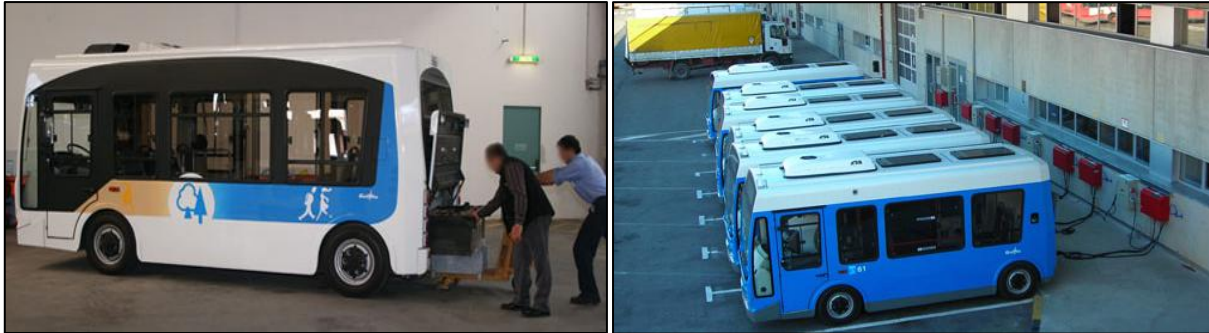
Figura 1: Gulliver base e Gulliver con batterie al Na/NiCl 2
