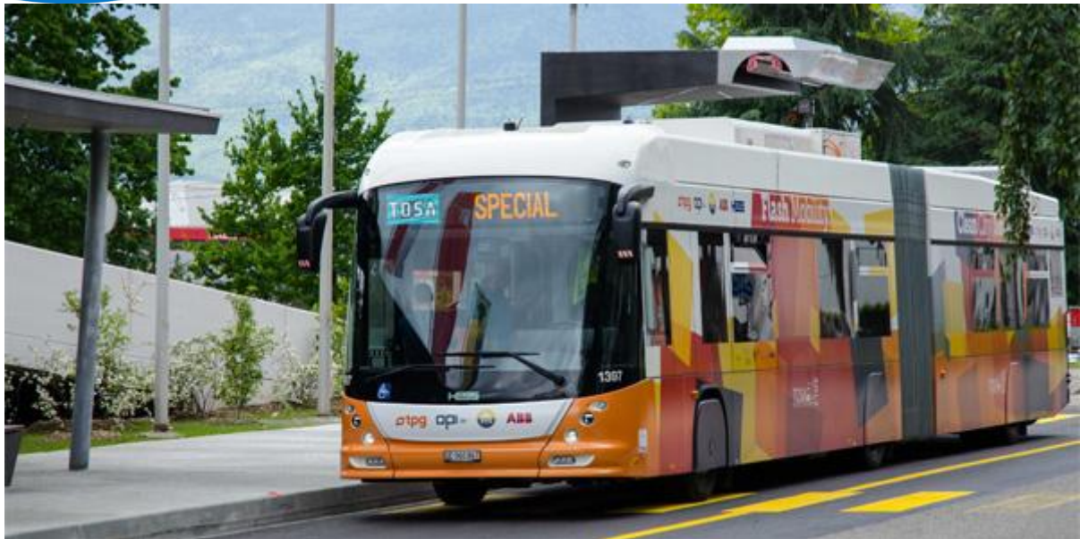
Figura 29: Autobus elettrico a ricarica automatica in c.c. con pantografo rovesciato
