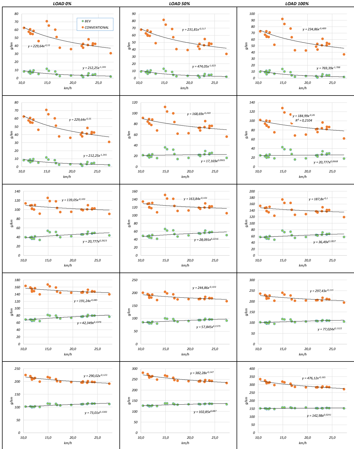
Figure 16 - Consumi specifici di combustibile calcolati per MINI Bus Convenzionali ed Elettrici
