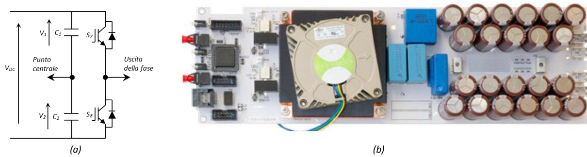
Figura 31. (a) struttura dell'unità base di tipo H-bridge, (b) foto dell'unità base di tipo H-bridge.
