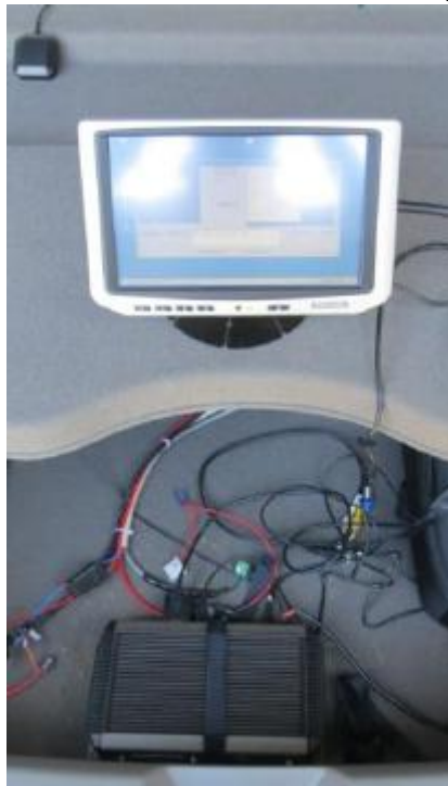
Figura 7 : sistema di acquisizione dati a bordo del veicolo
