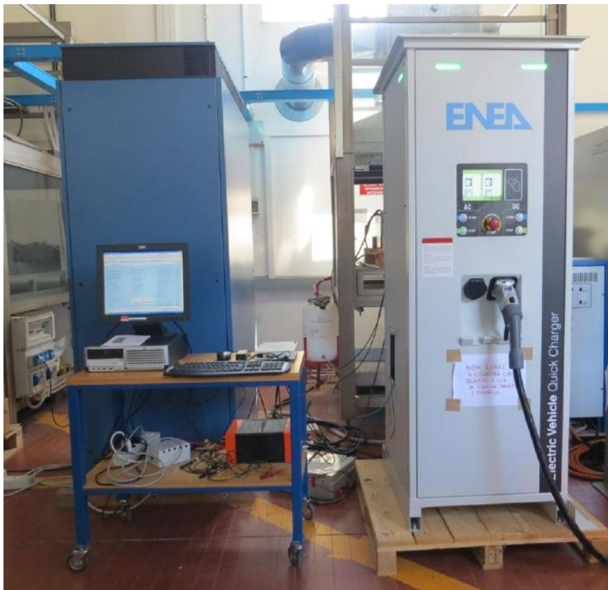
Figura 9 : stazione di ricarica da 50 kW c.c.
