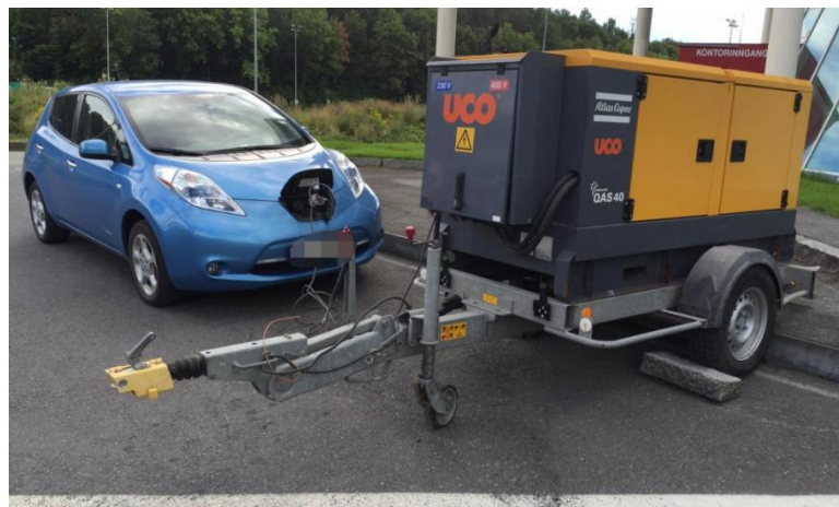
Figura 35 : servizio eseguito con motogeneratore trainato
