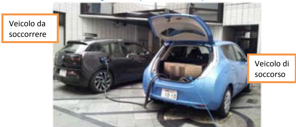
Figura 28 : esempio di ricarica con sistema ORCA Inceptive
