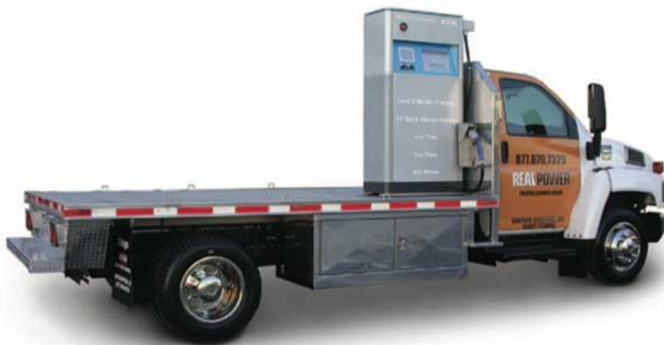
Figura 32 : Real Power sistema di ricarica di soccorso
