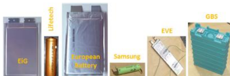
Figura 15. Foto delle celle analizzate.
